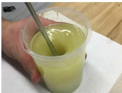
5. Mélanger l'eau avec un petit agitateur au moins une minute jusqu'à obtenir une substance homogène. Temps d'utilisation env. 15 minutes
