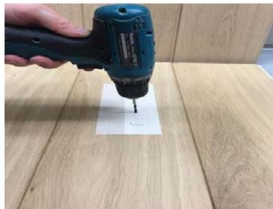
2. Percer la cavité d'aplomb, si nécessaire effectuer des perçages supplémentaires
