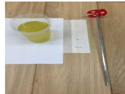
4. Mettre 300 ml de WAKOL MS 335 Résine de réparation dans un gobelet gradué
