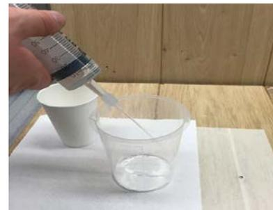
3. Ajouter 25 ml d'eau (pour 300 ml de WAKOL MS 335 Résine de réparation) avec la seringue
